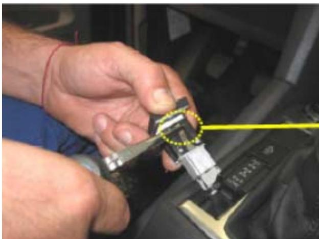
4. При помощи клещей загнуть пружинные фиксаторы переключателей на стороне водителя - влево или на стороне переднего пассажира - вправо.
