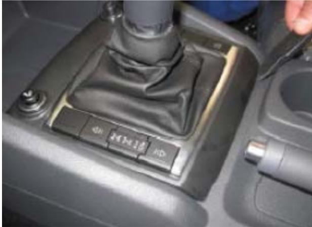
2. Отсоединить рамку на заднем участке при помощи пластмассового клина.
