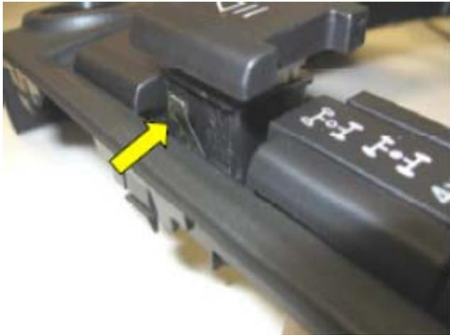
6. Дорабатывать следует только внешние пружинные фиксаторы переключателей.
