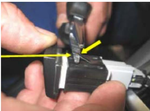
5. За счёт сгибания угол пружинного фиксатора уменьшается в направлении переключателя.
